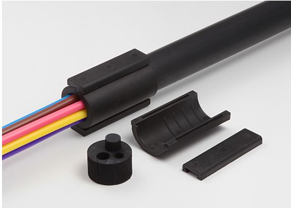
Die teilbare Rohrabdichtung eignet sich für die gas- und wasserdichte Abdichtung von 32 mm HDPE-Schutzrohren, die mehrere Subducts und/oder (Glasfaser-)Kabel enthalten.
