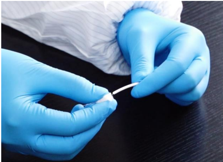
Abbildung 3.5 Abwischen der verbleibenden Mantelbeschichtung
