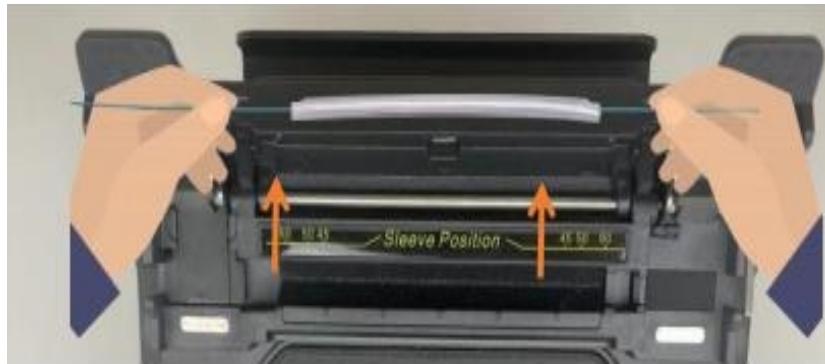
Abbildung 3.14 Abkühlen von Schrumpfschläuchen
