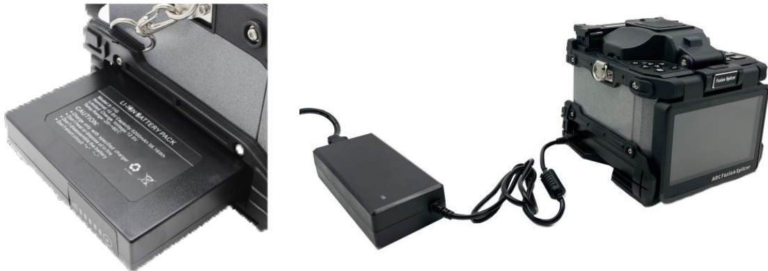
Abbildung 3.1 Einlegen des Akkus und Aufladung
